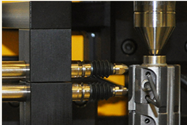
Abb. 55: untere radiale Einstellschraube einstellen
