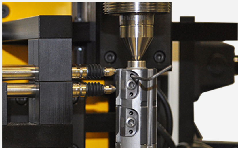
Abb. 54: obere radiale Einstellschraube einstellen
